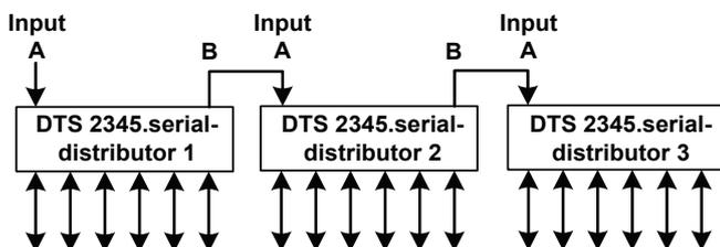
Ist eine höhere Anzahl Ausgänge nötig, können weitere serielle Signalverteiler ohne Inputsignal als kaskadierte Ausgangssignale verdrahtet werden.
